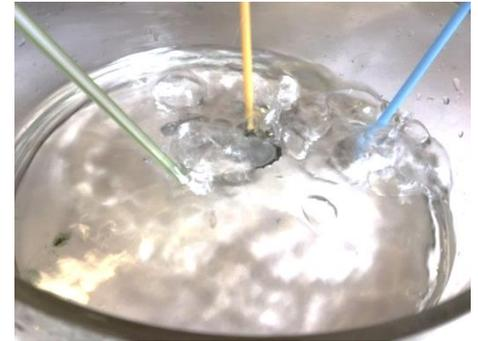
Abbildung 2: Das Einblasen von Luft führt zum Sinken des Kronkorkens
