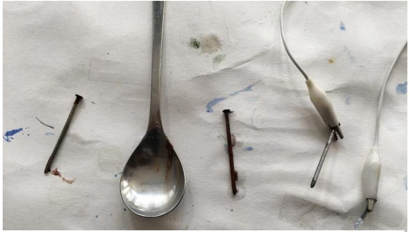
Abbildung 23: Nagel mit Nagellack - Edelstahlöffel - Nagel - Nagel mit Magnesiumband
